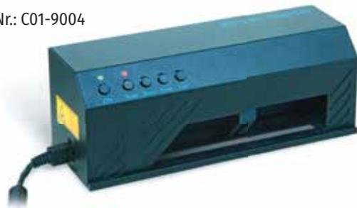
Das REA PC-Scan vereint eine motorgesteuerte Präzisions-Messeinheit mit einem Rotlicht-Halbleiterlaser. Die vom REA PC-Scan ermittelten Reflexionswerte sowie die Breiten der Striche und Lücken eines Strichcodes werden über die serielle Schnittstelle an einen PC, Laptop oder ein Notebook übertragen.
